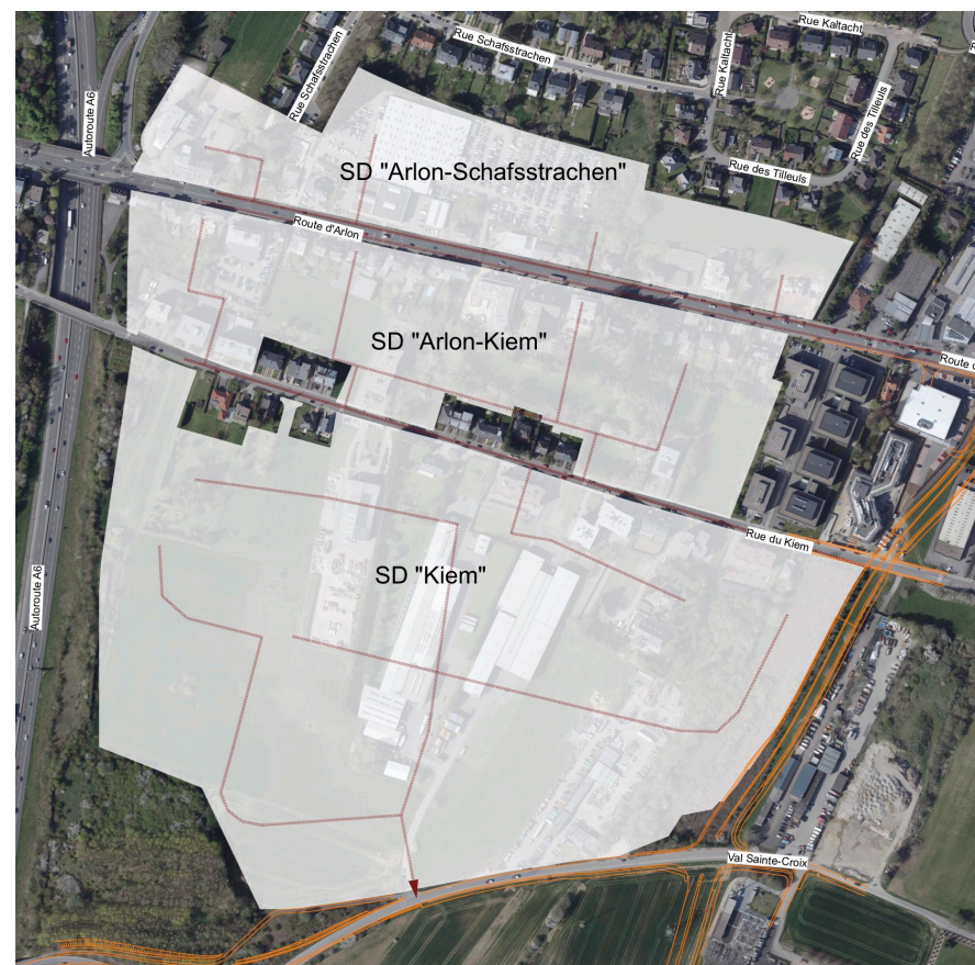
Abb. 11: Planung der Schmutzwasserachsen in den SD-Gebieten „Kiem“, „Arlon-Kiem“ und „Arlon-Schafsstrachen“ im Zusammenhang (Grundlage: Orthophoto, © TRIGIS GMBH Berlin (2016))
