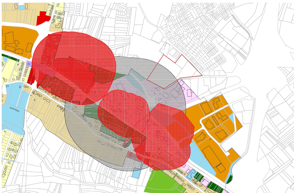
Abbildung 19: Überlagerung der aktuellen Gefahrenzone (grau schraffiert) und der zukünftigen Gefahrenzonen (rot schraffiert) der drei Seveso-Standorte im Umfeld der Planfläche (rot umrandet). Quelle: ITM, 2025
