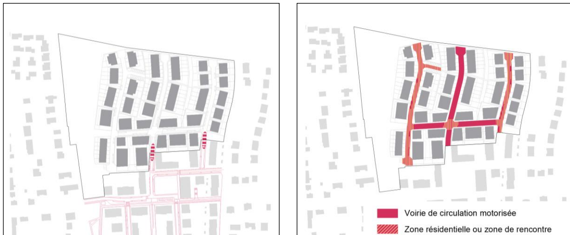
Figure 18 : Connexion du PAP aux voies desservantes existantes
