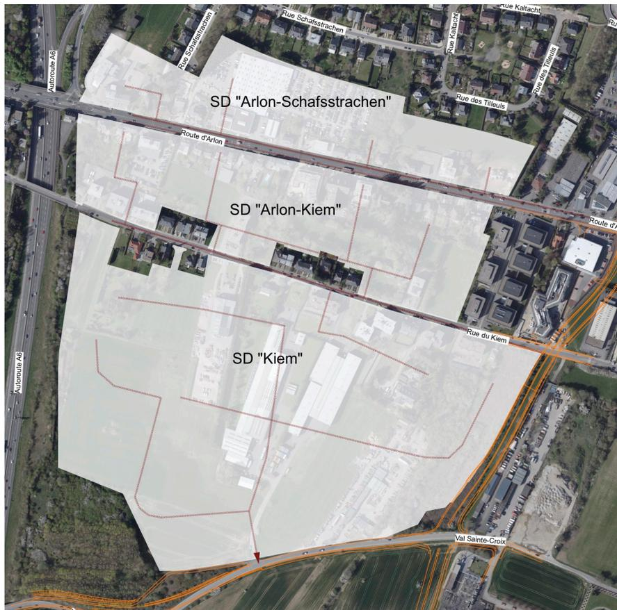
Abb. 12: Planung der Schmutzwasserachsen in den SD-Gebieten „Kiem“, „Arlon-Kiem“ und „Arlon-Schafsstrachen“ im Zusammenhang (Grundlage: Orthophoto TRIGIS GMBH Berlin, 2016)
