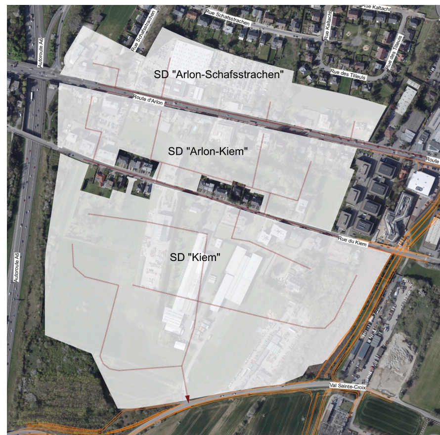
Abb. 10: Planung der Schmutzwasserachsen in den SD-Gebieten „Kiem“, „Arlon-Kiem“ und „Arlon-Schafsstrachen“ im Zusammenhang (Grundlage: Orthophoto TRIGIS GMBH, 2016)
