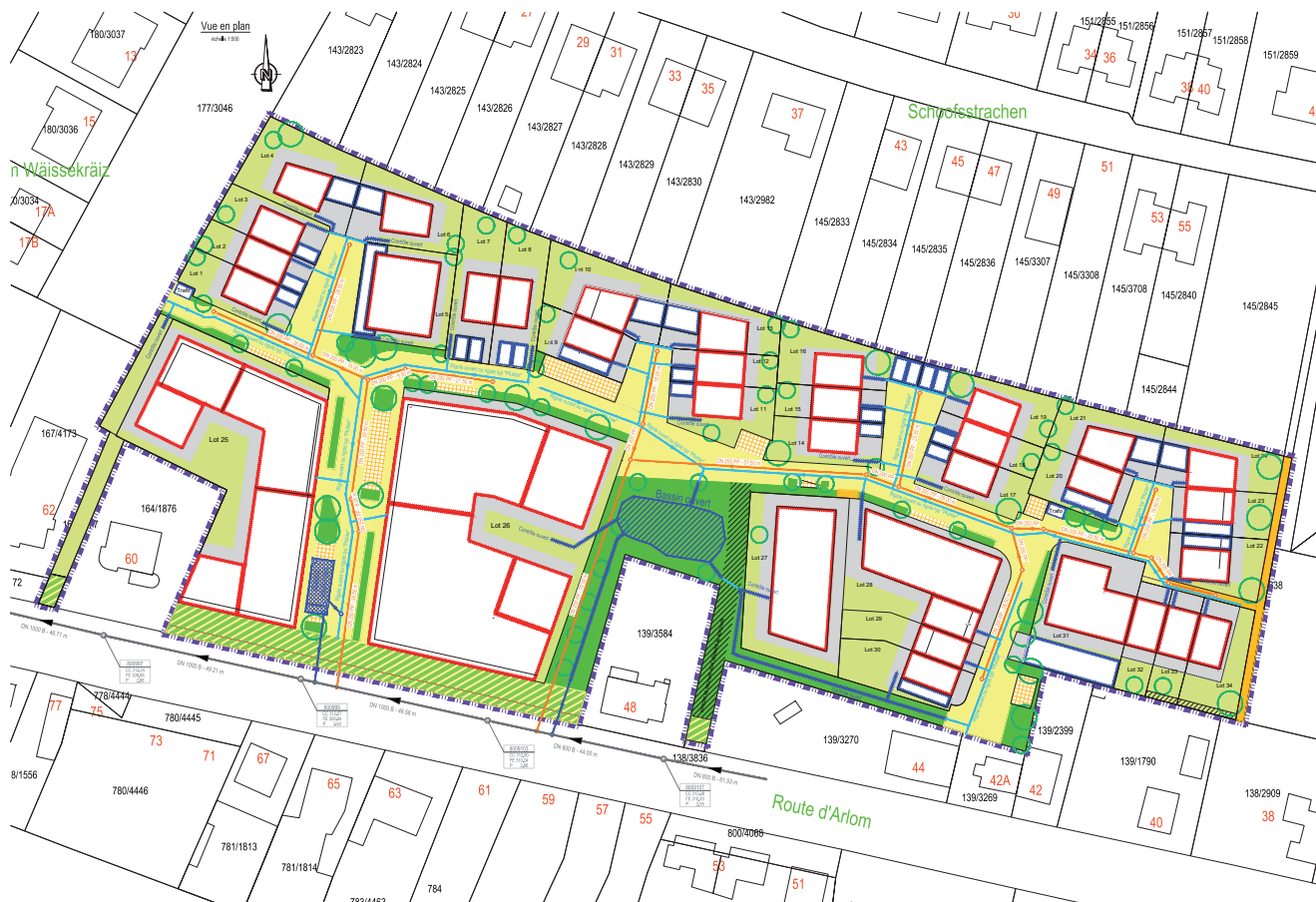
Fig.17: Concept d'évacuation des eaux pluviales et usées
