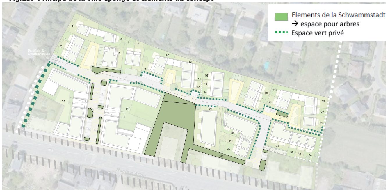
Fig.13: Principe de la ville éponge et éléments du concept
