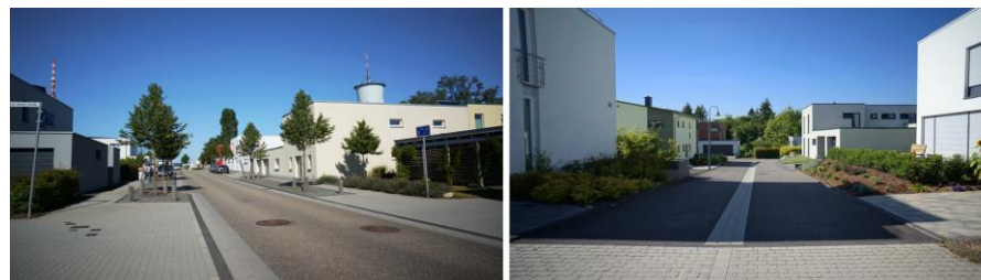
Abb. 12: Anliegerstraße im Trennprinzip/Tempo-30-Zone (links) und Wohnstraße/zone résidentielle – Tempo-20 im Mischprinzip (rechts), Quelle: a+a, eigene Aufnahmen Karsten Harz
