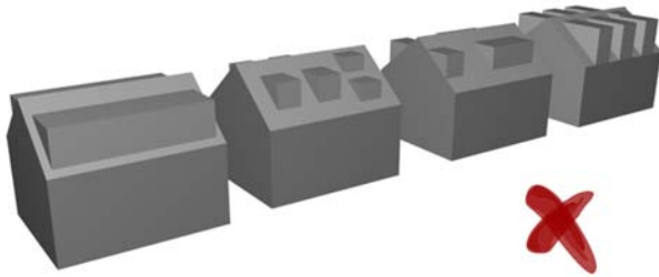
Abb. III.9: Beispiele für unzulässige Dachaufbauten
